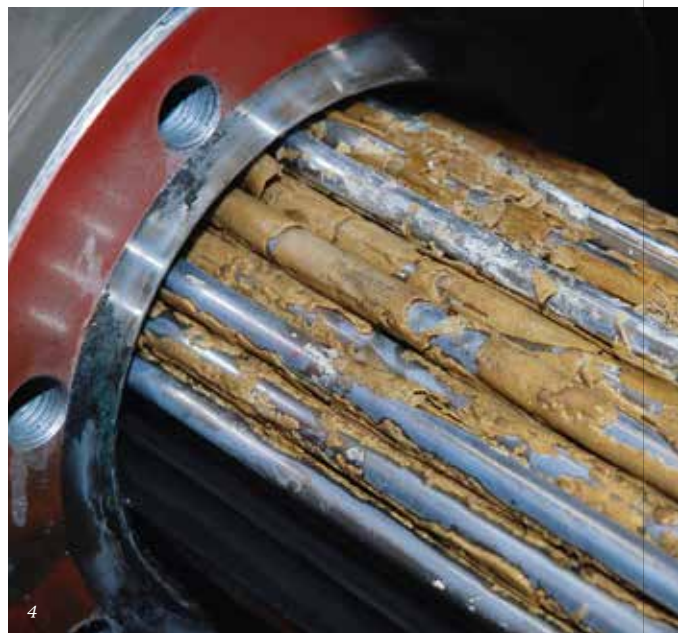
BILDER 1 40 Zentimeter hohe Kalkablagerungen auf dem Speicherboden im Warmwasserspeicher 2 Verkalkter Glattrohr-Wärmeübertrager in einem Liegendspeicher 3 Verkalkter Kupfer-Rippenrohr-Wärmetauscher aus einem Pufferspeicher 4 Rohrbündelübertrager mit Kalkablagerungen
