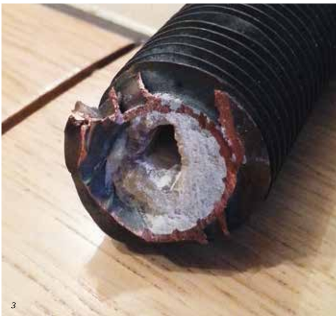
BILDER 1 40 Zentimeter hohe Kalkablagerungen auf dem Speicherboden im Warmwasserspeicher 2 Verkalkter Glattrohr-Wärmeübertrager in einem Liegendspeicher 3 Verkalkter Kupfer-Rippenrohr-Wärmetauscher aus einem Pufferspeicher 4 Rohrbündelübertrager mit Kalkablagerungen
